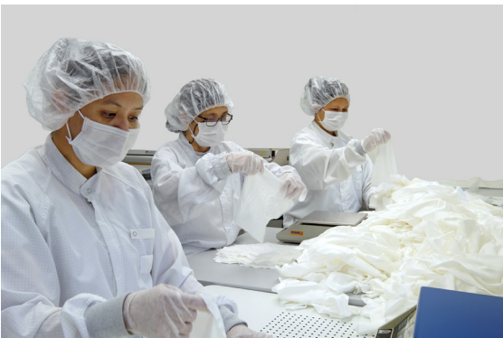
Abb. 12 Der Legeraum im Ostseewerk. Dort werden die Tücher im ISO-Klasse 5 Reinraum von Colandis Kahla visuell einzeln geprüft und verpackt.
