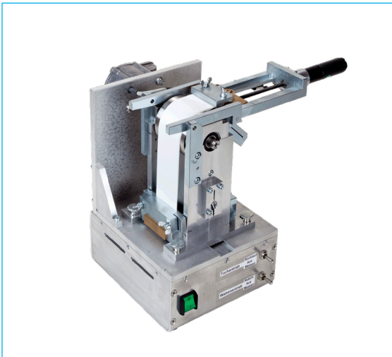
Abb. 6 Rotations-Wischsimulator Mark III nach Labuda/Schöttle zur Bestimmung der Reinigungs-Effektivität von verschiedenen Wischmitteln.
