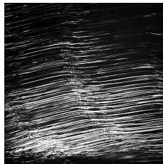
Abwischen eines Fingerabdrucks mit nicht dekontaminiertem Reinigungstuch Maschendichte 400 = deutliche Schlieren
