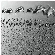
Zusätzliche Verunreinigung mit 5000 ppm Mineralöl, Rand-Ausschnitt, 100fache Vergrößerung
