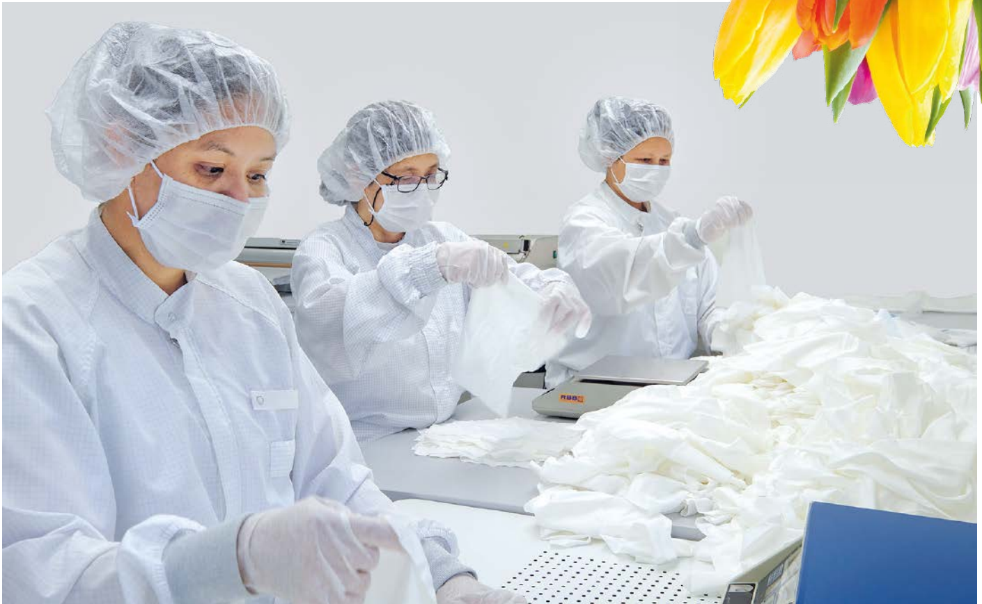
Abb. 11: Der Legeraum im Ostseewerk. Dort werden die Tücher im ISO-Klasse 5 Reinraum von Colandis Kahla visuell einzeln geprüft und verpackt.
